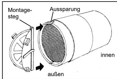
Lüftereinsatz in das Montagerohr einschieben, Montagesteg der Winddrucksicherung dabei senkrecht positionieren, Spannungsversorgung anschließen, Innenblende mit Filterrahmen aufsetzen.
