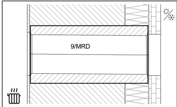
Mauerwerk mit Wärmedämmverbundsystem und Vorhangfassade
