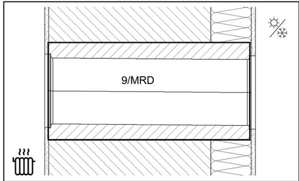
Mauerwerk mit Wärmedämmverbundsystem und Klinkerfassade
