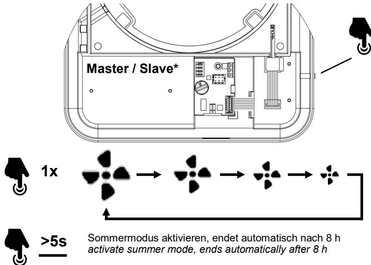
\* Über den Taster des Masters wird das gesamte System bedient. Eine Bedienung des Slaves ändert die Stufe an diesem für 1 h, nach dieser Zeit gibt der Master wieder die Stufe vor. Eine Stufenänderung am Master wird nach 5-7s vom Slave übernommen.
