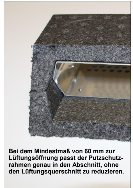
Ein präziser 45°-Schnitt ergibt einen perfekten 90°-Winkel für die Umlenkung des Lüftungsspalt nach vorn.
